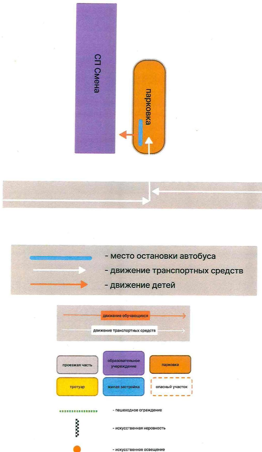
5. Схема № 5. План-схема пути передвижения транспортных средств и детей при проведении дорожных ремонтно-строительных работ вблизи СП «Смена» МАОУ ДО ДДТ «У Белого озера» (ул. Междугородная, 24)
